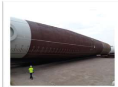
Pile ( \approx 100 m)
